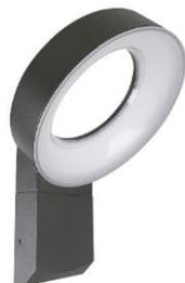
Luminario decorativo para colocar en muro, carcasa de aluminio, color gris, pantalla PC, índice de protección IP65, lámpara integrada LED, tensión nominal de 100-127V, consumo de potencia de 20 W, frecuencia nominal de 60 Hz, consumo de corriente de 0.20 – 0.16 A, factor de potencia de 0.9, flujo luminoso de 1400 lm, temperatura de color 4,000K, luz blanca fría, ángulo de apertura 120°, IRC 80, temperatura de operación de -10 -40°C, 30,000 horas de vida, no atenuable, garantía de 3 años.
