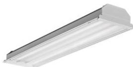
Luminario de sobreponer, con dimensiones de 121.90 cm de largo x 31.10 cm de ancho y 12.10 cm de altura, gabinete con marco abatible, fabricado en acero laminado en frío de una sola pieza, acabado con pintura poliéster en polvo aplicado electrostáticamente, difusor fabricado con polímero de alto peso molecular, integrado por 2 lámparas fluorescentes de 2 x 32W T8, voltaje de 120-277V, balastro electrónico de arranque instantáneo. Garantía limitada de 1 año.
