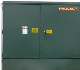
Transformador tipo pedestal de 30 KVA trifásico con voltaje de operación primario de 13,200 volts y un voltaje secundario de 220/127 volts 3 fases marca, operación radial.
