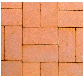
Adoquin de barro 100% natural extruido y cocido a 1000°C con dimensiones de 5.70 cm x 10.00 cm x 20.00 cm, 50 piezas x m2, con un peso nominal de 2.10 kg por pieza, 18% absorción de agua, resistencia a la compresión de 594.8 kg/cm2
